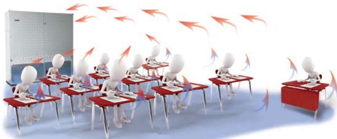
Rys. 2. Zasada działania: świeże powietrze nawiewane jest dołem, nad podłogą, następnie wznosi się i jest odbierane z powrotem u góry
