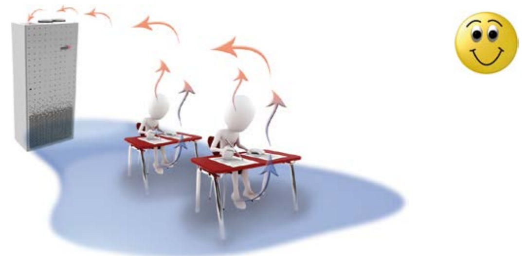
Rys. 3a. Wentylacja wyporowa (konwekcja)
