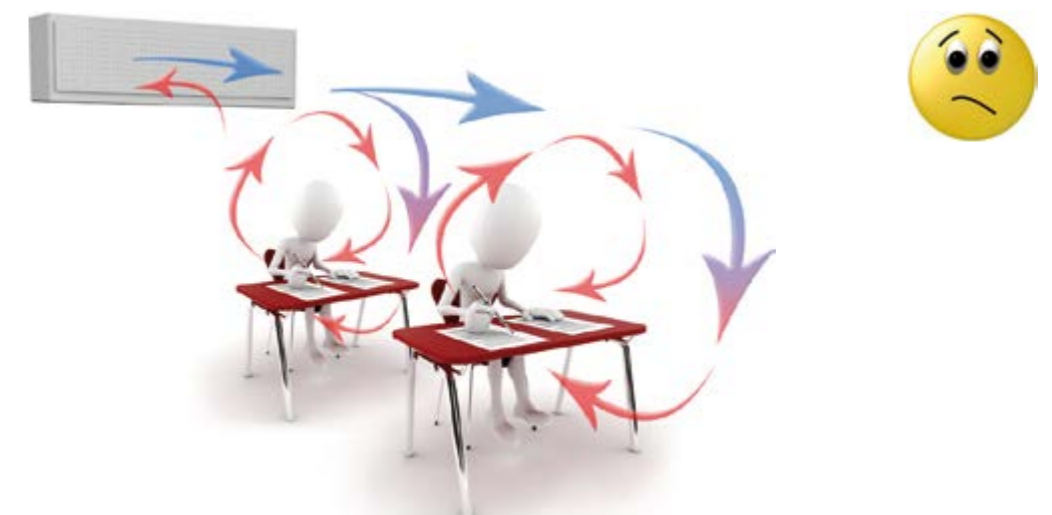
Rys. 3b. Wymuszone, turbulентne rozprowadzenie powietrza
