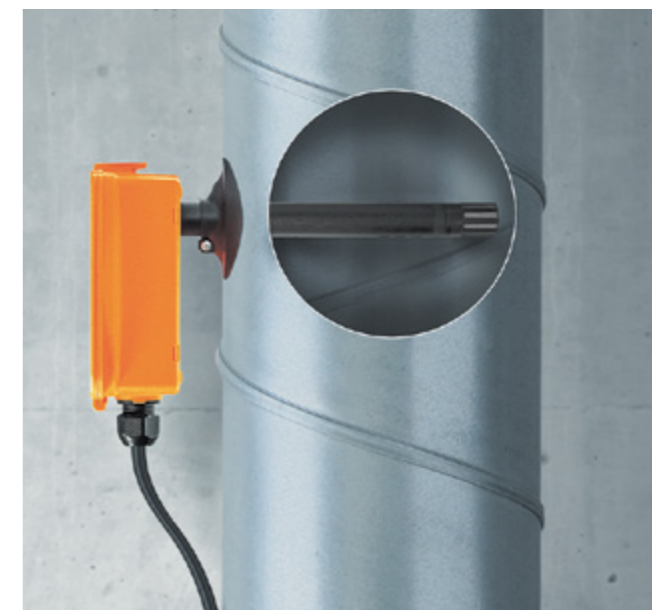
Rys. 1. Czujnik jakości powietrza w przewodzie wentylacyjnym. Gwarantuje uzyskanie optymalnej jakości powietrza w pomieszczeniach o podwyższonym komforcie oraz oszczędności energii w budynkach. Dostępne są różne warianty pomiarów: CO 2 , CO 2 + Temp., CO 2 + Wilgotność + Temp., CO 2 + LZO, CO 2 + LZO + Temp., CO 2 + LZO + mieszanka CO 2 /LZO + Temp. Źródło: Belimo
