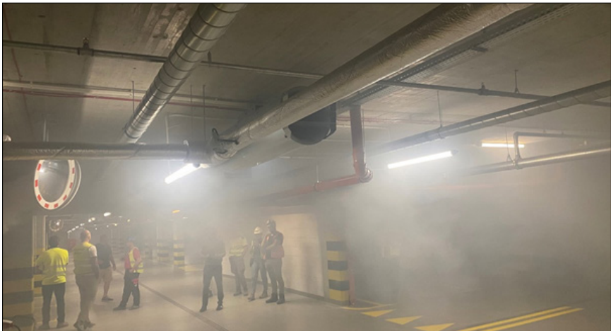
Fot. 4. Zadymienie podczas próby z gorącym dymem przed uruchomieniem systemu oddymiania wentylacji strumieniowej
