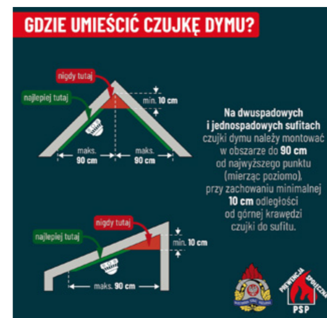
Rys. 3. Zalecane miejsca montażu czujek dymu na sufitach dwu- i jednospadowych Źródło: Wydział Prewencji Społecznej KG PSP
