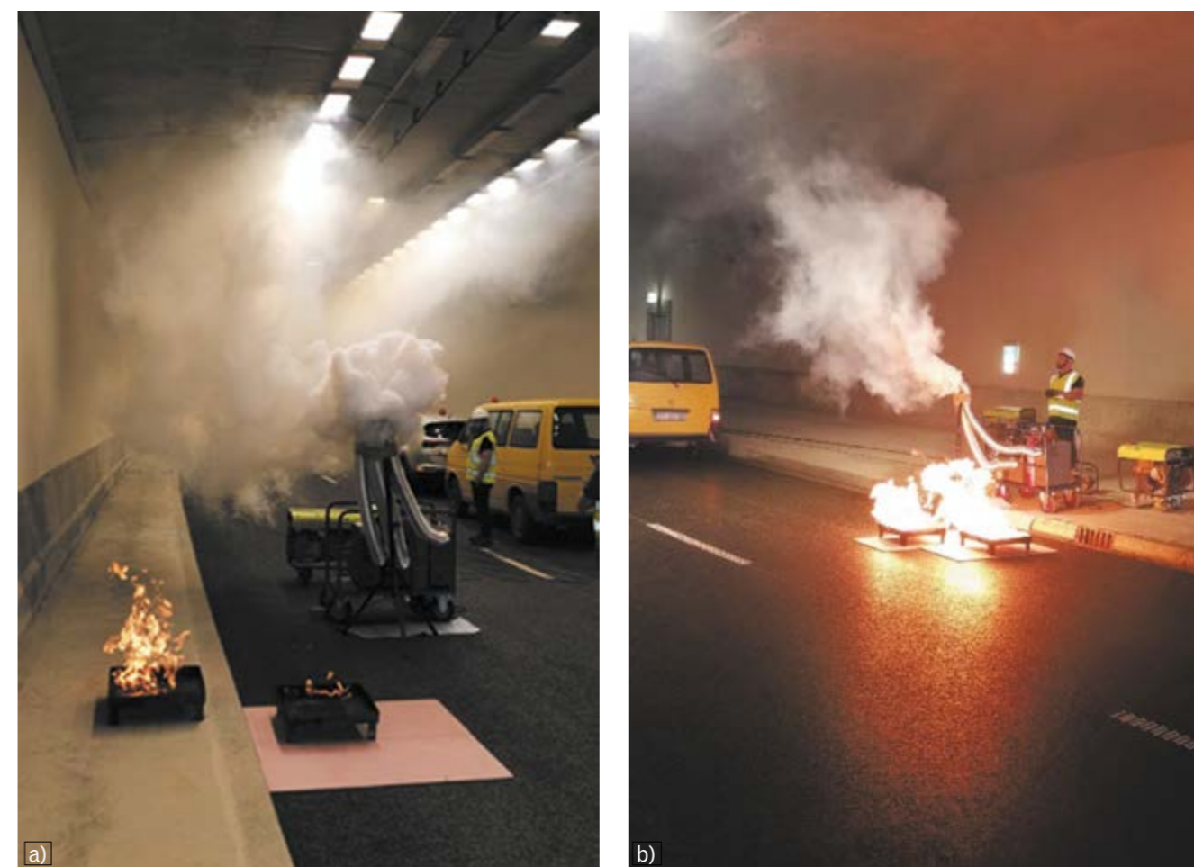
Fot. 4. Próby dymowe w tunelu: a) w trakcie ewakuacji, b) w czasie pracy systemu oddymiania Źródło: Neuron
