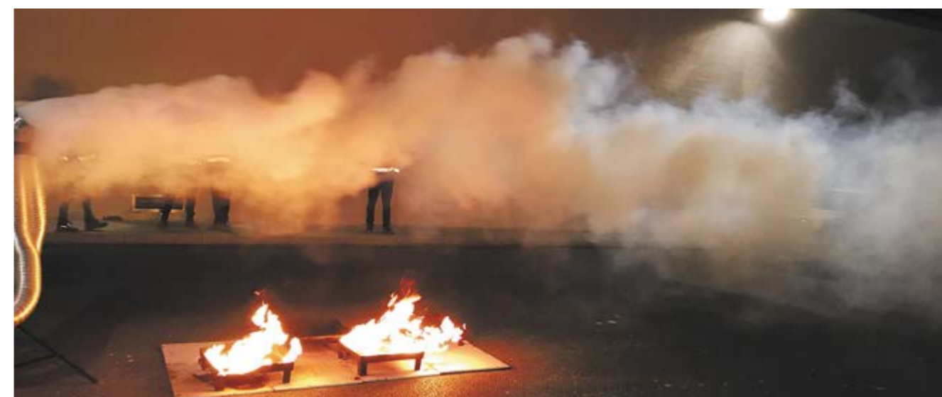
Fot. 5. Próby dymowe w tunelu drogowym – widoczne przemieszczanie się dymu po przejściu systemu w tryb akcji ratowniczo-gaśniczej Źródło: Neuron
