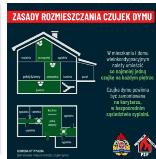
Rys. 4. Zasady rozmieszczania czujek dymu Źródło: Wydział Prewencji Społecznej KG PSP
