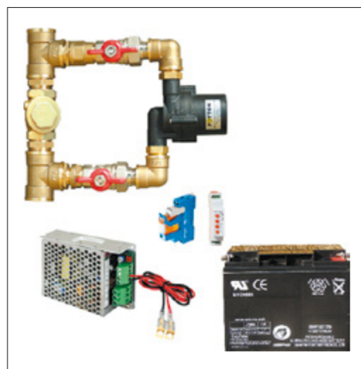
Fot. 4. Elementy awaryjnego systemu podtrzymania obiegu w monoblokowej pompie ciepła: by-pass z pompą obiegową, zasilacz awaryjny i akumulator, przełączniki, obudowa
