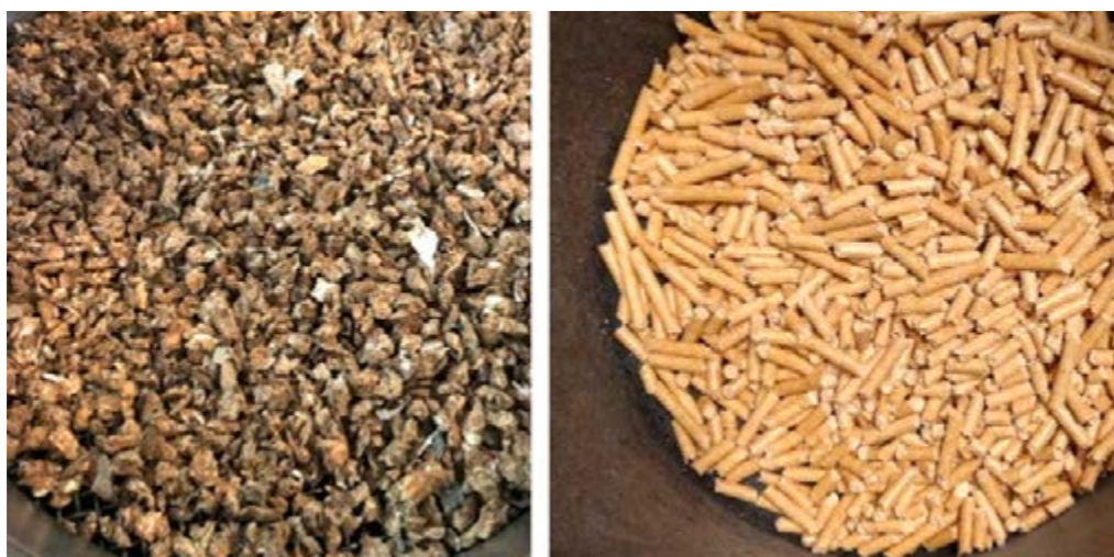
Pellet złej jakości (zawierający odpady polimerowe) – z lewej oraz pellet dobrej jakości (z prawej) Źródło: Instytut Technologii Paliw i Energii
