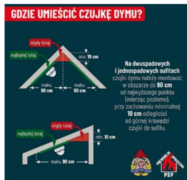
Rys. 1. Zalecane miejsca montażu czujek dymu na sufitach dwu- i jednospadowych Źródło: Wydział Prewencji Społecznej KG PSP
