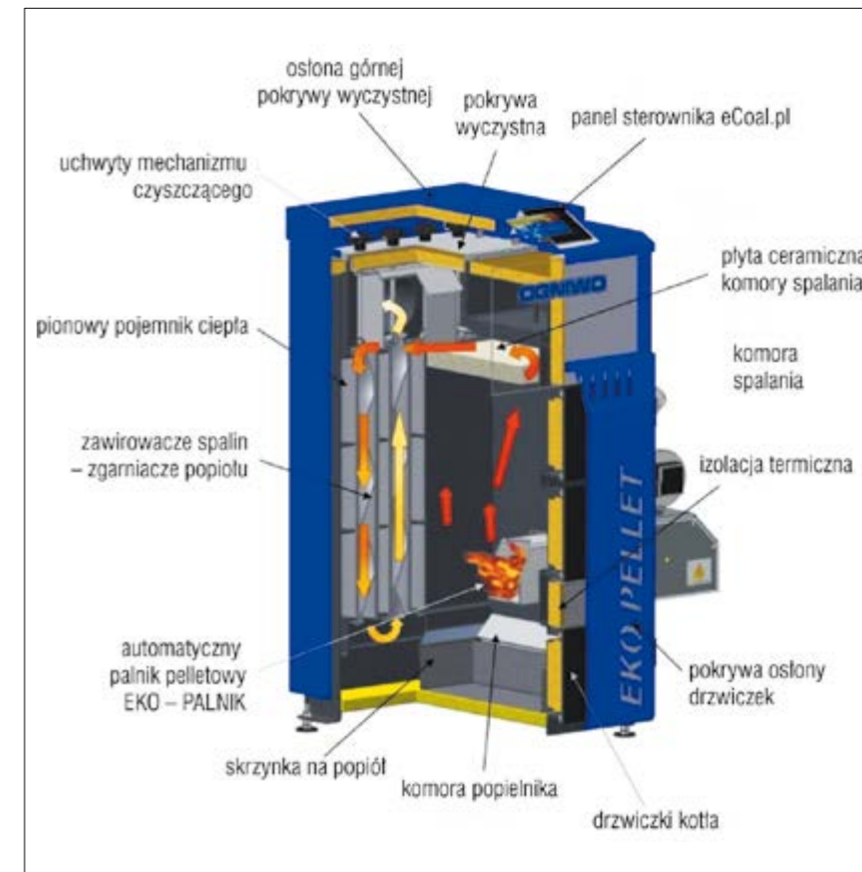
Rys. 14. Kocioł na pelety z palnikiem zewnętrznym – budowa [5]
