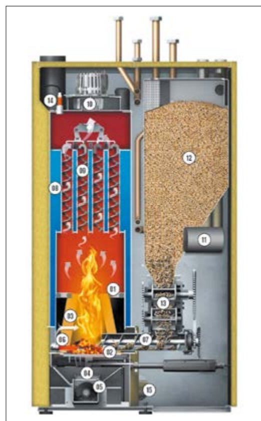
Rys. 7. Kocioł z poziomym podajnikiem śrubowym i dozownikiem celkowym [2]. Opis: 01 – ceramiczna komora spalania, 02 – przesuwany ruszt, 03 – kanały powietrza wtórnego, 04 – powietrze pierwotne, 05 – szuflada popielnika, 06 – automatyczna zapalarka, 07 – ślimak podający paliwo, 08 – wymiennik ciepła, 09 – turbulatory z automatycznym czyszczeniem wymiennika, 10 – wentylator wyciągowy, 11 – „pompa” do peletu, 12 – zintegrowany zasobnik paliwa, 13 – podwójne koło celkowe, 14 – sonda Lambda (w standardzie), 15 – przyłącze powietrza RLU/RLA
