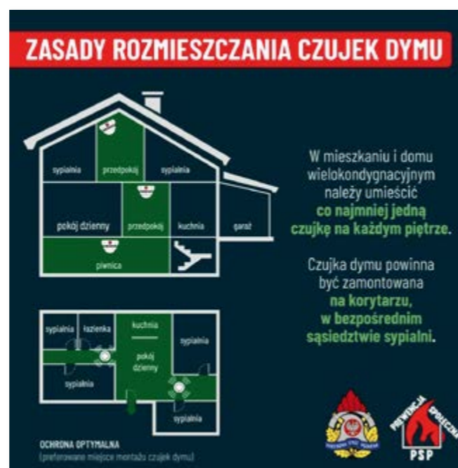
Rys. 2. Zasady rozmieszczania czujek dymu Źródło: Wydział Prewencji Społecznej KG PSP
