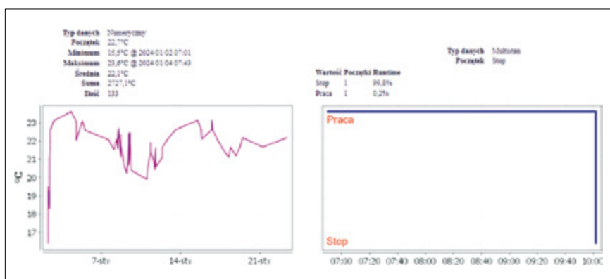
Rys. 7. Układ dostał informację o pracy 3 stycznia, wcześniej temperatura nawiewu wynosiła 15,5°C, co świadczy o jego wyłączeniu w celu minimalizacji zużycia energii elektrycznej Źródło: EL-PIAST
