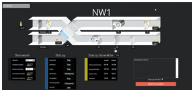
Rys. 2. Wizualizacja centrali klimatyzacyjno-wentylacyjnej NW1. Widoczny wymiennik krzyżowy, dwa filtry na wlotach powietrza, przepustnice, wentylatory nawiewu i wywiewu, nagrzewnica oraz chłodnica Źródło: EL-PIAST
