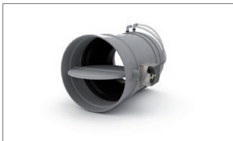
Fot. 4. Regulator VAV (przepustnica regulacyjna) do pracy w instalacjach ze zmiennym przepływem – wykonanie z tworzywa sztucznego (PVC lub PP) pozwala na stosowanie urządzenia w instalacjach, gdzie mogą wystąpić związki agresywne chemicznie Źródło: Smay
