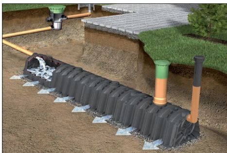
Fot. 3. Tunel rozsączający – schemat i elementy instalacji.
