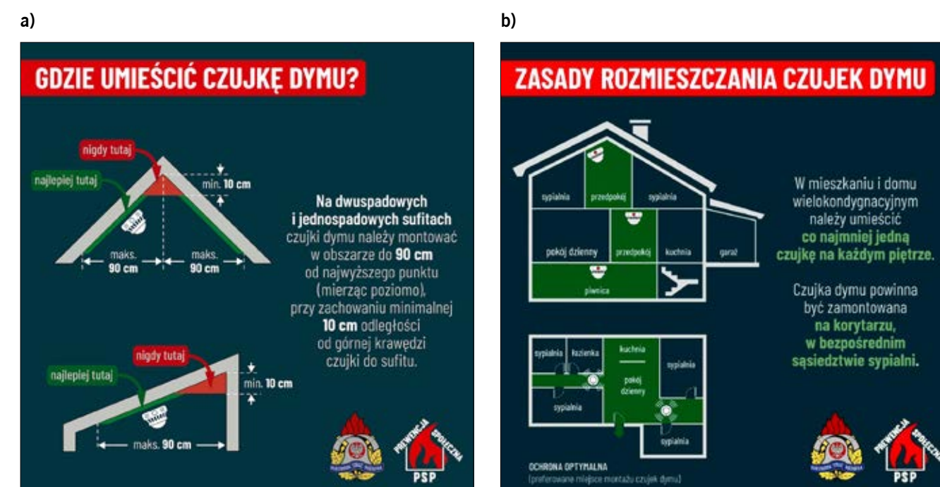
Rys. 1. Zalecane miejsca montażu czujek dymu: a) w pomieszczeniach i na kondygnacjach, b) na sufitach dwu- i jednospadowych
