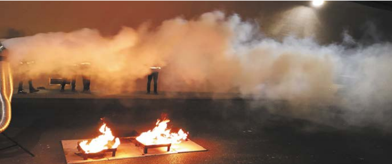
Fot. 5. Próby dymowe w tunelu drogowym – widoczne przemieszczanie się dymu po przejściu systemu w tryb akcji ratowniczo-gaśniczej
