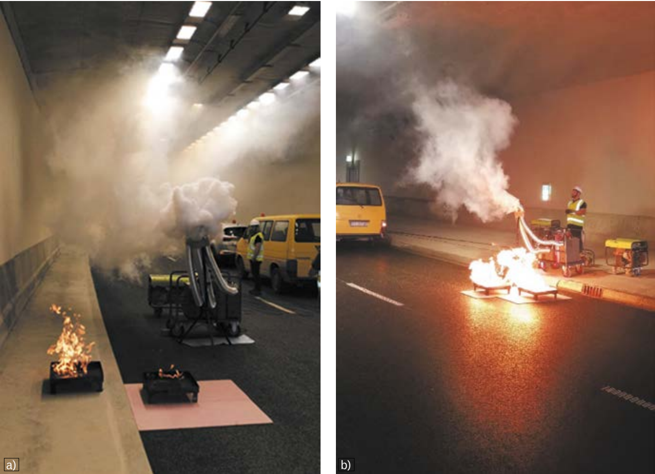
Fot. 4. Próby dymowe w tunelu: a) w trakcie ewakuacji, b) w czasie pracy systemu oddymiania
